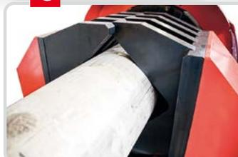
Unità produttiva automatica strutturalmente robusta e al contempo di facile utilizzo. La morsa, grazie al particolare design, assicura un serraggio autocentrante e antideformazione. Presente a bordo macchina un pannello di controllo per la gestione di tutte le funzioni della macchina. La SB500 può utilizzare utensili facilmente intercambiabili, sia integrali sia a placchetta.
