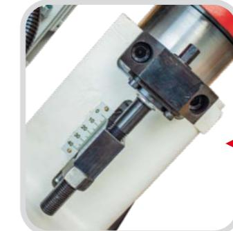
Agire sulla vite per regolare la profondità di passata controllando la quota sulla scala graduata.
