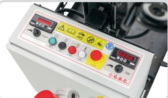
Intuitivo e estremamente facile nell'utilizzo tramite il display digitale, il nuovo dispositivo consente di varia-re la velocità della fresa da 300 g/min a 1500 g/min.
