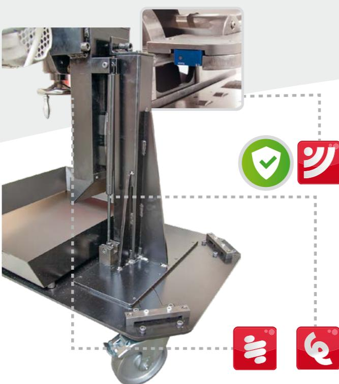
La macchina è dotata di sensore rilevazione presenza lamiera e di carrello con nuovo sistema di convogliamento del truciolo. Si è inoltre adottato un doppio sistema di ammortizzazione che permette di ovviare ad eventuali imperfezioni nello spessore della lamiera, ad eventuali variazioni nell'allineamento della stessa, nonché alle imperfezioni del suolo.
