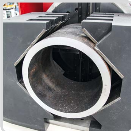
dettagli morsa autocentrante details of the locking vice
