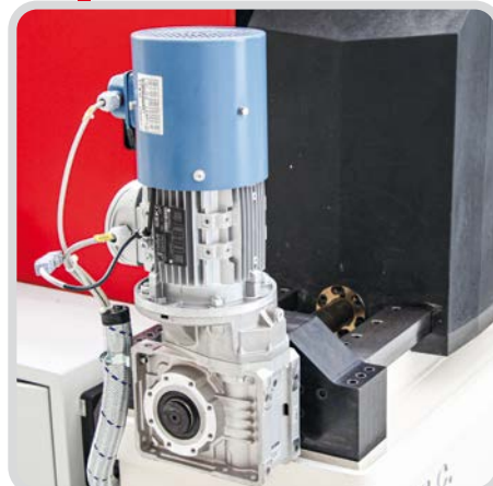
dettaglio motore avanzamento testa mobile details of the mobile head feeding motor
